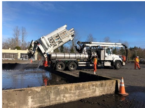
Foto: Para el mantenimiento de desagües se necesitan vehículos con herramientas y bombas especiales.
